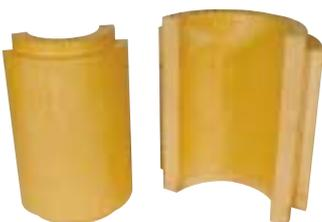
Les systèmes à berceaux simples et multiples en PUF sont fabriqués en accord avec l'ASTM C-585 et sont pourvus de joints (radiaux et longitudinaux). Ceci assure un verrouillage fiable avec chaque couche de fourrure calorifuge adjacente sur site et empêche que la vapeur passe directement à la surface du calorifuge.
